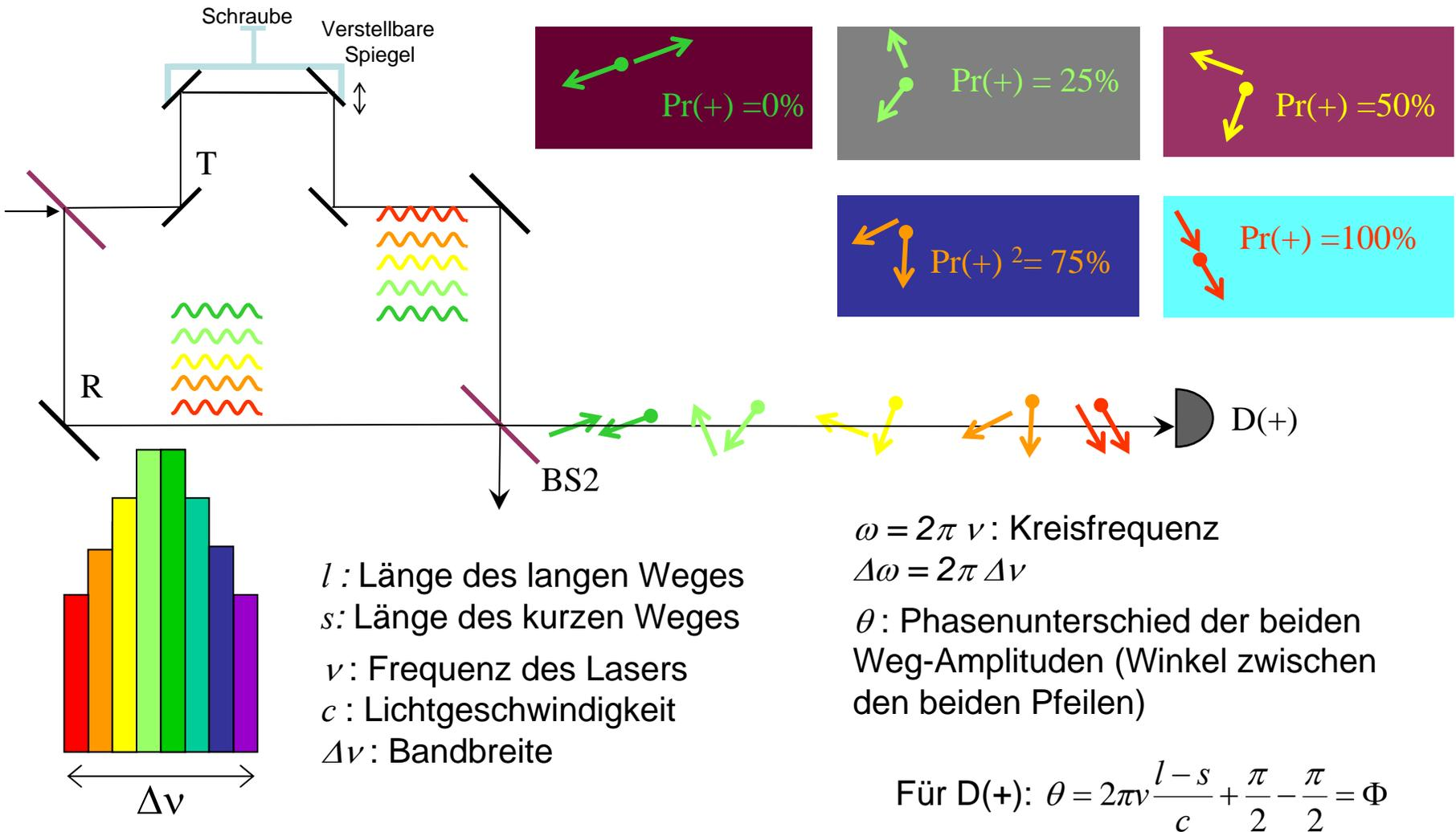
Wenn es in der Bandbreite für jede Frequenz eine andere Frequenz gibt, so dass  $\Phi_2 - \Phi_1 = \pi$ , die durchschnittliche Zählrate ergibt 50%.
